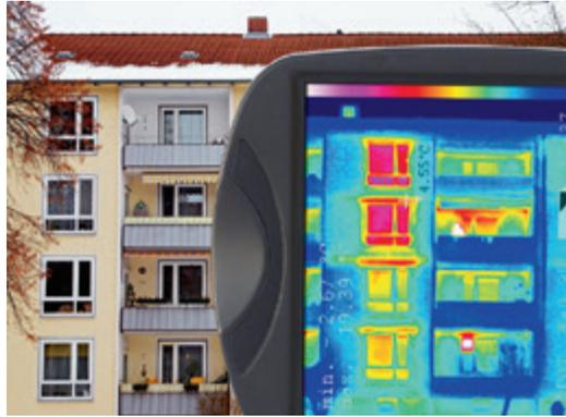
Mit Hilfe von Wärmebildern können wir exakt festhalten, wo es zu einem teuren Energieverschleiss kommt.
